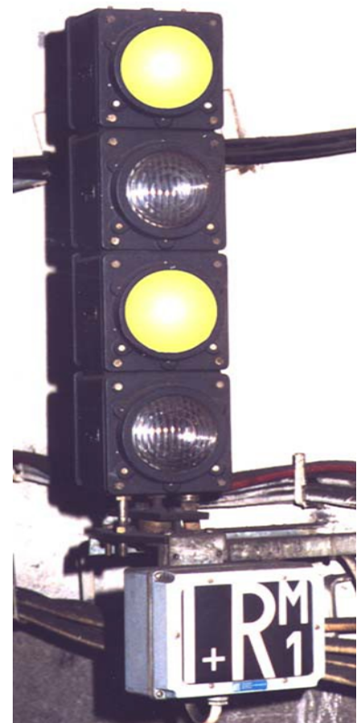
Signal d'espace intermédiaire + Répétiteur de signal de manœuvre
